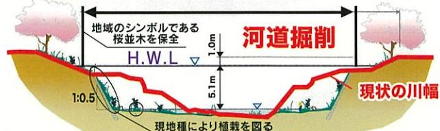
延長約2.8km(桜大橋付近～新竹生橋付近)において、川の中の土砂を除去して洪水時の水位を低下させるほか、堤防の高さが低いところは嵩上げをします。
